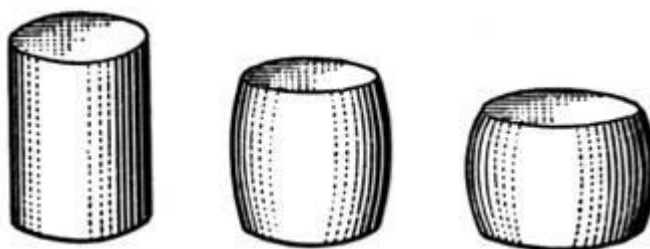
Рис. 2.1. Деформация стального образца при сжатии
