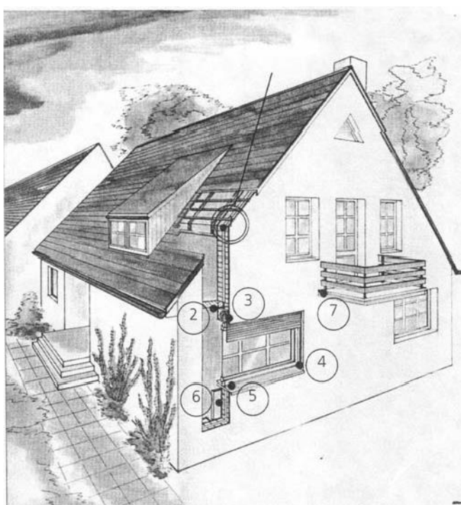
Рис.8.6. Потери энергии в деталях строений (критические зоны)
