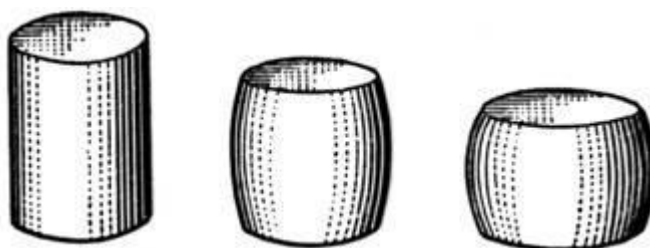
Рис. 2.1. Деформация стального образца при сжатии
