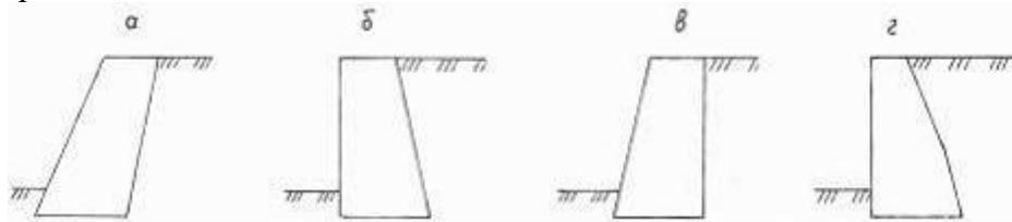
с уклоном в сторону, противоположную засыпке (рис. б)
